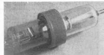
Aspetto del tubo artatron in una versione « miniatura ». Lungo circa dieci centimetri, questo tubo sopporta una tensione inversa di 35.000 V ed è in grado di fornire, in corrente continua, una intensità di 10 mA (e parecchi ampère di picco).
