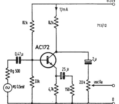
Fig. 5 - Preamplificatore per fonorivelatore magnetodinamico.
