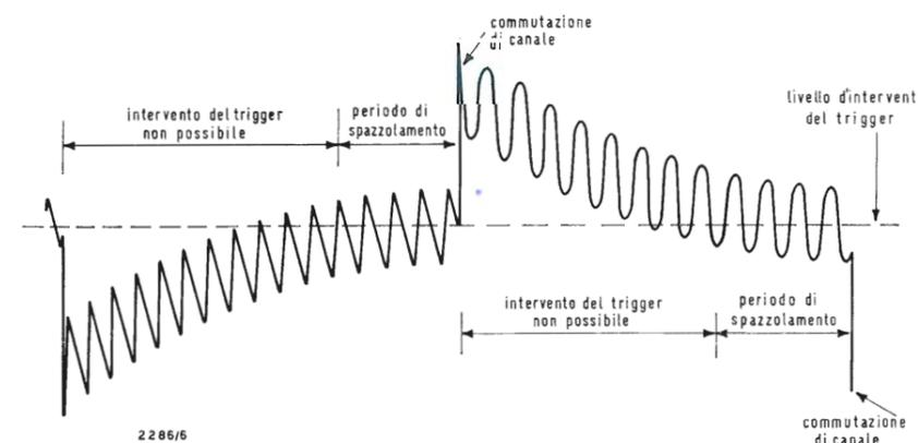
Fig. 4 - Dimostrazione di come avviene l'innescamento del trigger a condizione che i trigger miscelati siano accoppiati in c.a.
