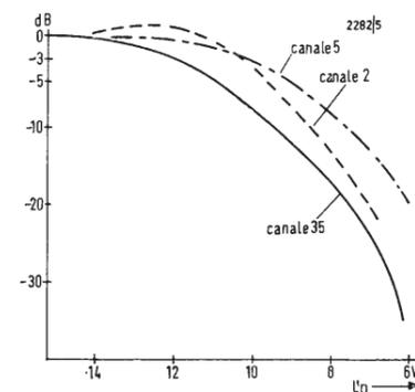
Fig. 4 - Variazione dell'amplificazione in funzione della tensione di regolazione, rilevata per un canale di ciascuna delle bande I, III e IV/V (canale 35 per entrambe queste ultime).
