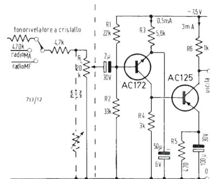
Fig. 1 - Preamplificatore per segnali di alto livello, generati da diodi rivelatori di radiorecettori.
