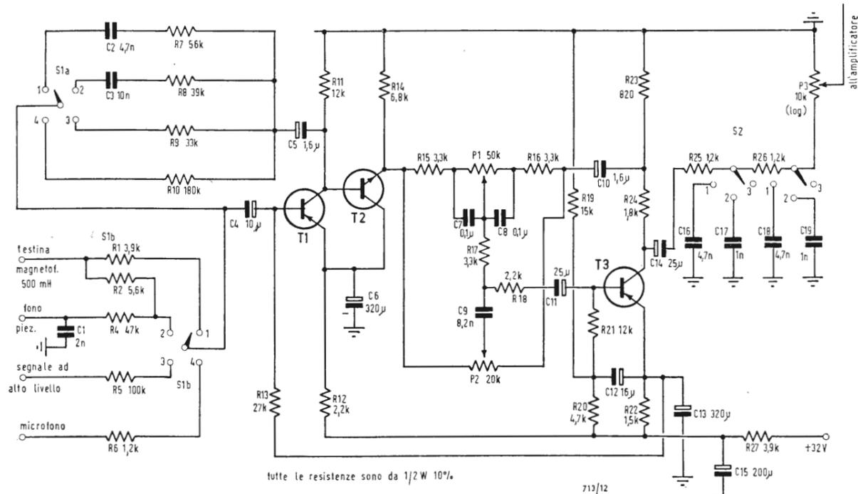
Fig. 6 - Preamplificatore per qualsiasi sorgente di programma.
