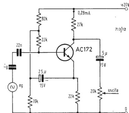
Fig. 3 - Preamplificatore per testina di riproduzione di magnetofono.
