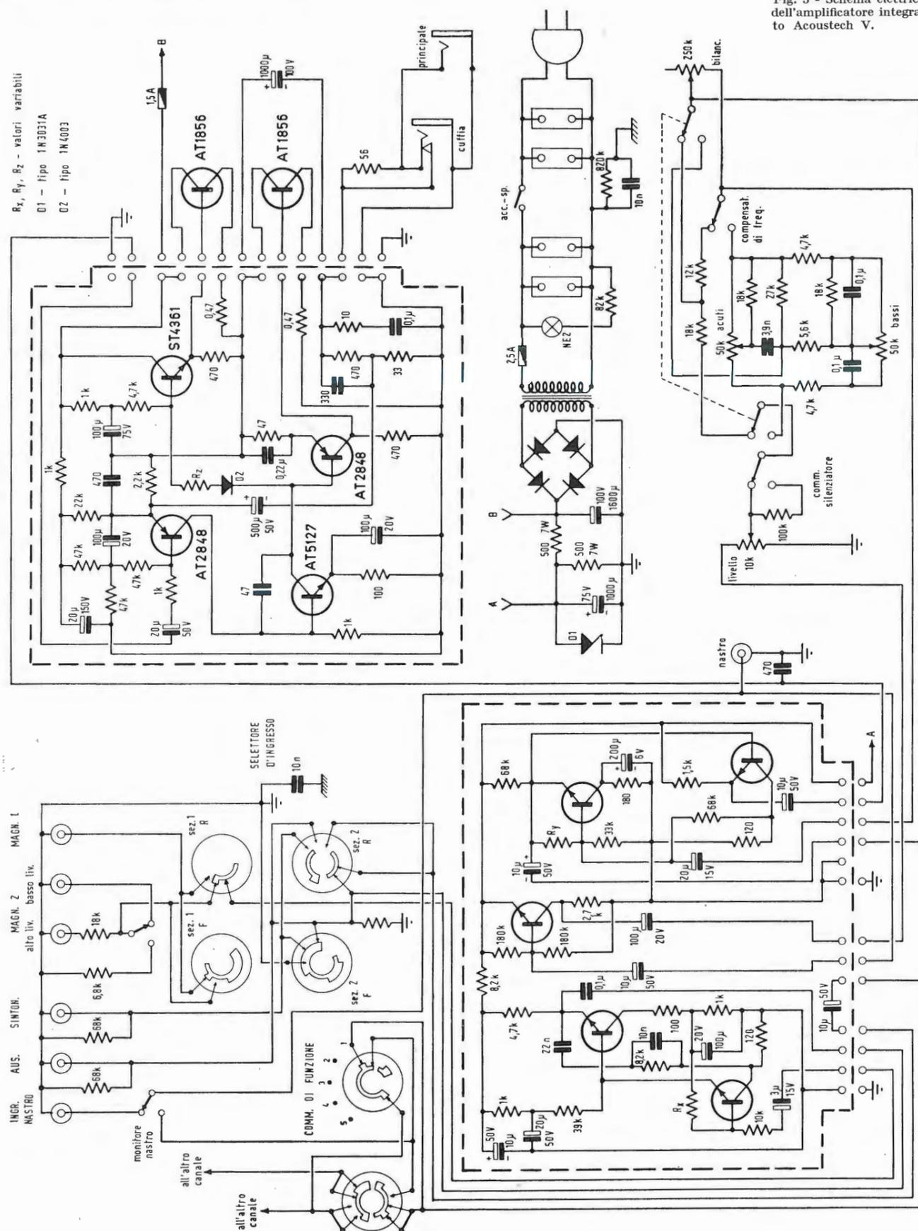
Fig. 5 - Schema elettrico dell'amplificatore integrato Acoustech V.
