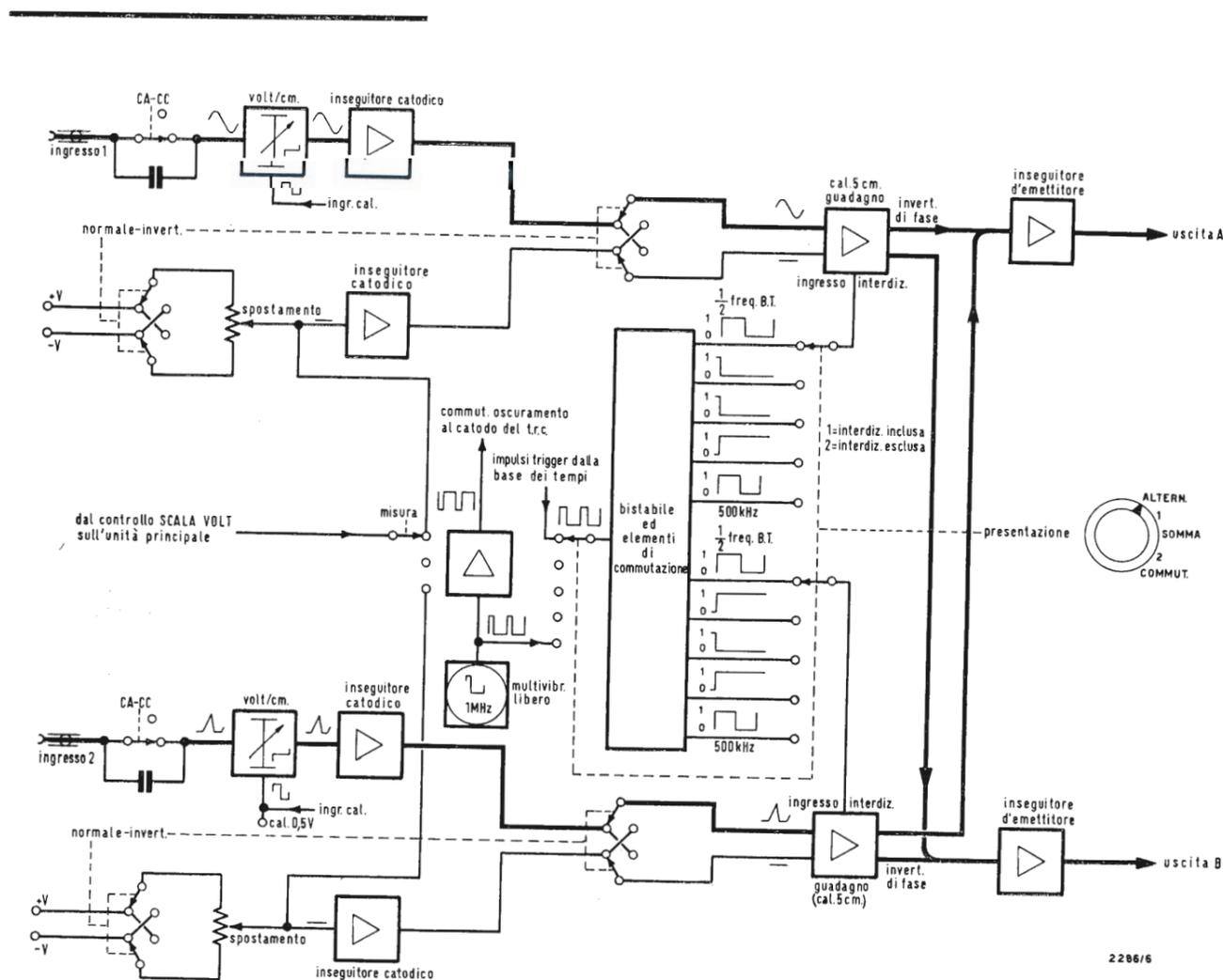
Fig. 1 - Schema a blocchi dell'unità a doppia traccia usata nell'oscilloscopio a stato solido Marconi Instruments TF 2201.
