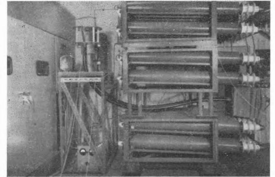
Il tubo artatron utilizzato in commutazione (sistema denominato «crow-bar»); sulla fotografia si distingue la batteria dei voluminosi condensatori da cui l'energia deve essere diretta verso la bobina mediante l'impiego del tubo. Questi esperimenti sono stati condotti per conto del C.E.A.
