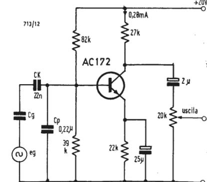
Fig. 4 - Preamplificatore per microfono dinamico.
