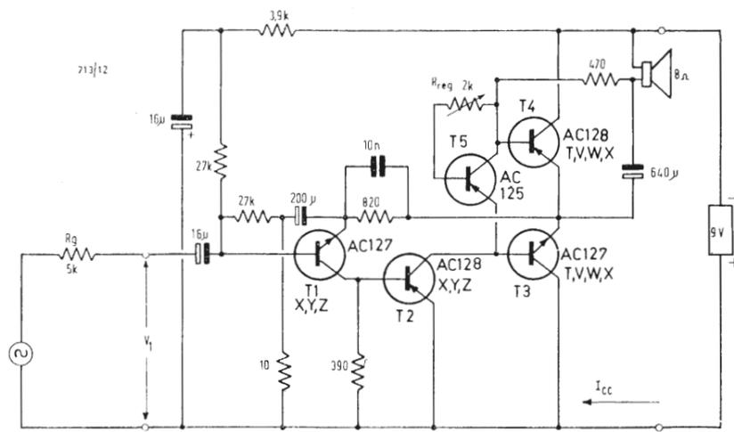
Fig. 11 - Amplificatore in classe B, 1 W, 9 V, a transistori complementari.
