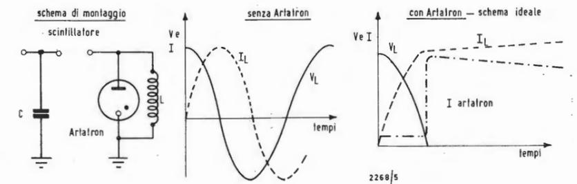
Fig. 4 - Nel sistema denominato «Crow-bar», l'artatron è montato in parallelo con una bobina (a); l'intensità di corrente che percorre quest'ultima, in assenza del tubo, avrebbe l'andamento illustrato dalla curva (b); con la presenza del tubo, detta intensità si mantiene invece pressoché costante (c).
