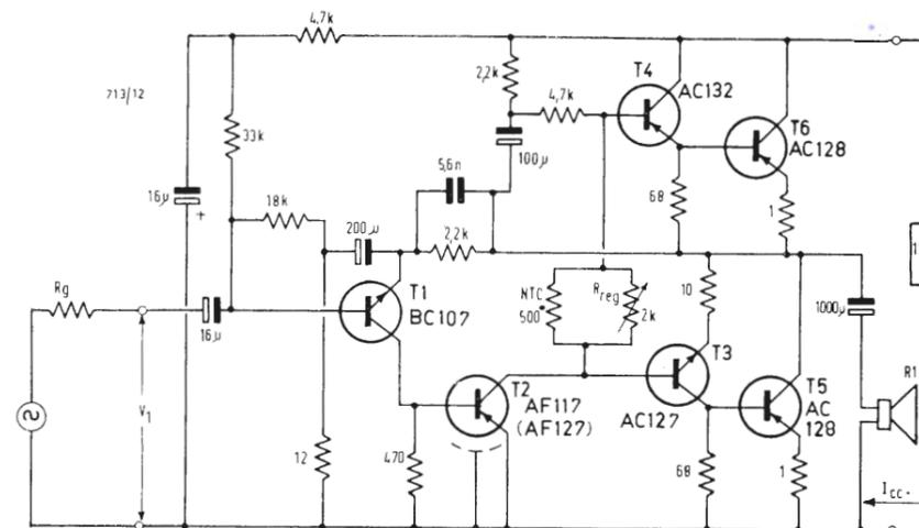
Fig. 12 - Amplificatore in classe B, 1,8 ÷ 2 W, 12 V.
