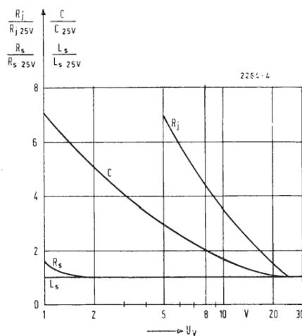
Fig. 3 - Dipendenza dalla tensione dei parametri del cristallo e di esecuzione del diodosintonizzatore BA141, con  $C_{25V} = 2,5$  pF;  $R_{S25V} \approx 0,5$   $\Omega$ ;  $R_{j25V} \approx 25$  M $\Omega$ ;  $L_{S25V} \approx 3,5$  nH.
