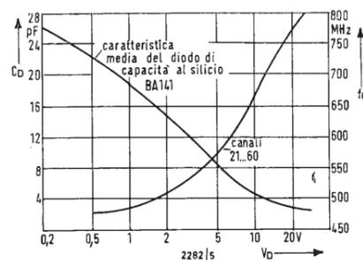
Fig. 3 - Andamento della curva caratteristica del diodo di capacità BA141 e frequenza dei canali da 21 a 60 ottenibili (bande IV e V) in funzione della tensione del diodo.
