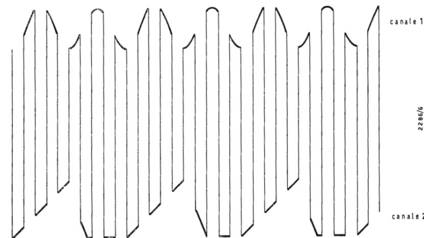
Fig. 6 - Una tipica forma d'onda composta ricavata dall'amplificatore Y comune, con funzionamento a interruzione.
