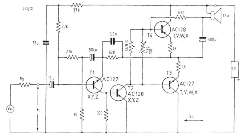
Fig. 10 - Amplificatore in classe B, 0,5 W, 9 V, a transistori complementari.
