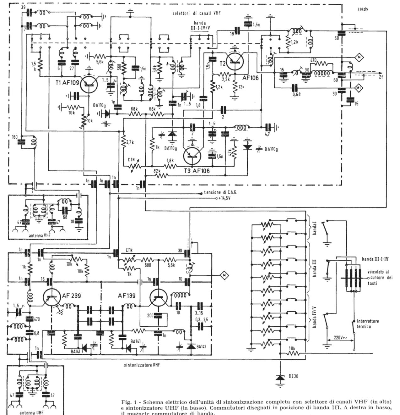
Fig. 1 - Schema elettrico dell'unità di sintonizzazione completa con selettore di canali VHF (in alto) e sintonizzatore UHF (in basso). Commutatori disegnati in posizione di banda III. A destra in basso, il magnete commutatore di banda.
